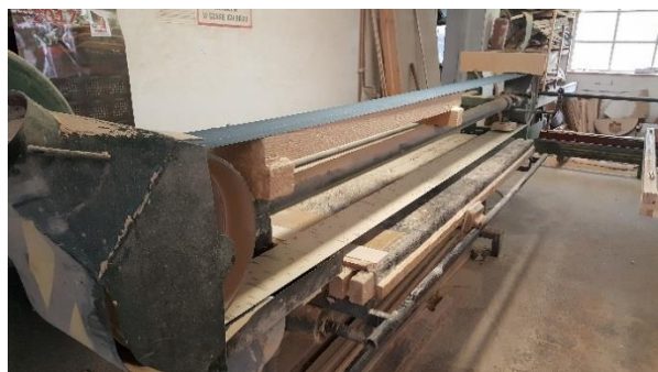
Szlifierka taśmowa – dostęp do taśmy szlifierskiej w części nieroboczej, a także do bębna napędowego oraz zwrotnego taśmy
