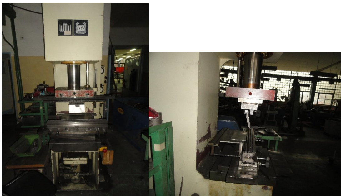
Prasa hydrauliczna, z prędkością ruchu tłoczyska przekraczającą prędkość bezpieczną, z przyrządem o budowie otwartej i sterowaniem przy użyciu pedału nożnego, niewyposażona w żadne elementy chroniące operatora i jego kończyny przed dostaniem się do strefy pracy maszyny
