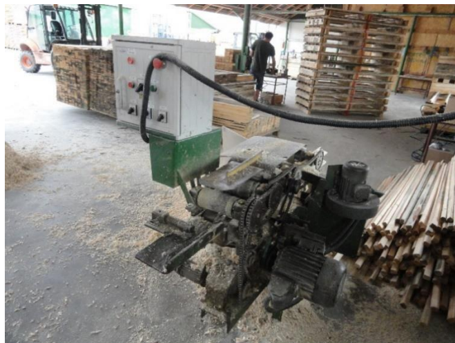
Przykład „twórczości” użytkownika w zakresie obrabiarki do drewna. Strugarka własnej konstrukcji bez zabezpieczenia dostępu do elementów i stref niebezpiecznych
