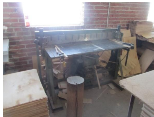
Gilotyna o napędzie elektrycznym. Brak osłon stref niebezpiecznych (strefy pracy noża tnącego oraz pełnej osłony przekładni pasowej napędu)
