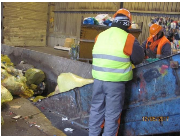
Praca w strefie zagrożenia podczas ręcznego rozcinania worków z odpadami w trakcie pracy sprzętu zmechanizowanego podczas zasypu kanału przenośnika taśmowego
