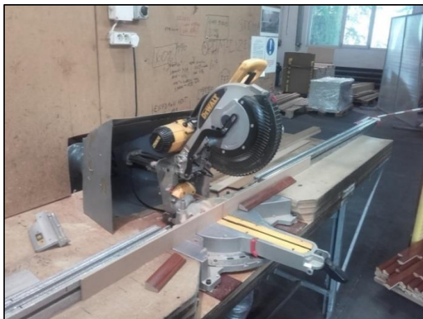
Piła tarczowa wahadłowa, podczas obsługi której poszkodowany doznał obrażeń
