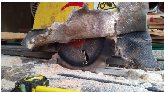
Pilarka tarczowa – obrzynarka. Brak skutecznej osłony lub innych urządzeń ochronnych ograniczających bezpośredni dostęp do strefy niebezpiecznej, tj. strefy pracy piły oraz śruby mocującej piłę
