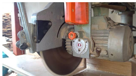
Pilarka tarczowa do cięcia poprzecznego. Brak w dolnej części jakiegokolwiek osłony – możliwy bezpośredni dostęp do strefy niebezpiecznej
