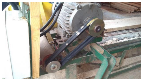
Pilarka tarczowa – obrzynarka. Brak osłony lub innych urządzeń ochronnych ograniczających dostęp do przekładni pasowej napędu piły
