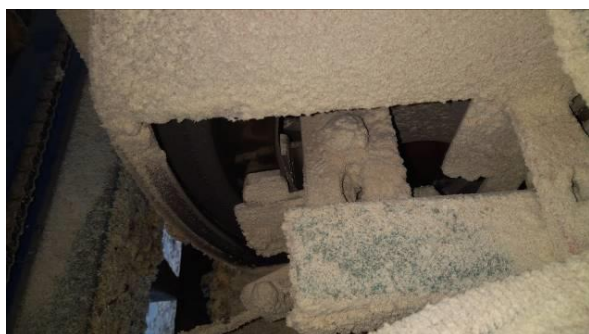
Brak skutecznych osłon bądź innych urządzeń ochronnych ograniczających bezpośredni dostęp do ruchomych elementów układu napędowego piły taśmowej od strony silnika, w tym elementów mechanicznego hamulca
