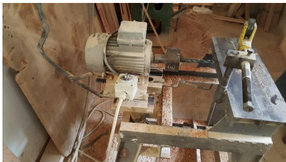
Bezpośredni dostęp do wrzeciona oraz narzędzia roboczego urządzenia własnej konstrukcji do frezowania pod zamek drzwi
