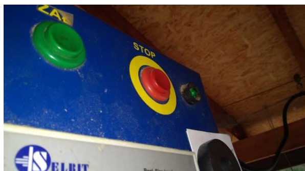
Przycisk pełniący funkcję urządzenia do zatrzymania awaryjnego
