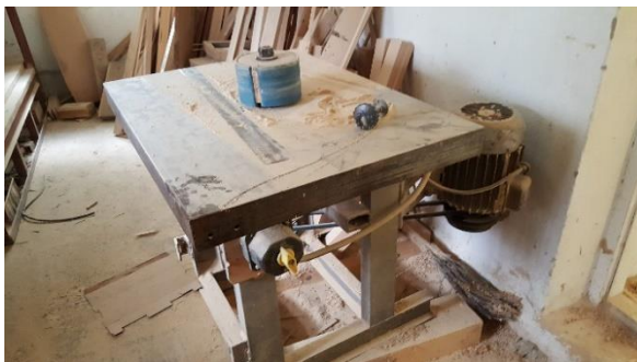
Bezpośredni dostęp do wałka szlifierskiego oraz przekładni napędu pasowego szlifierki taśmowej dolnowrzecionowej
