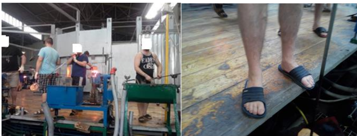
Negatywny przykład dopuszczenia pracowników do pracy bez odzieży roboczej i obuwia przy wanny z płynnym szkłem, przy wydmuchaniu wyrobów szklanych. Własna odzież niespełniająca wymagań bhp, klapki kąpielowe jako obuwie robocze
