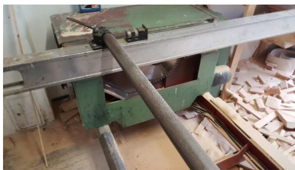
Bezpośredni dostęp do piły pod blatem roboczym pilarki tarczowej
