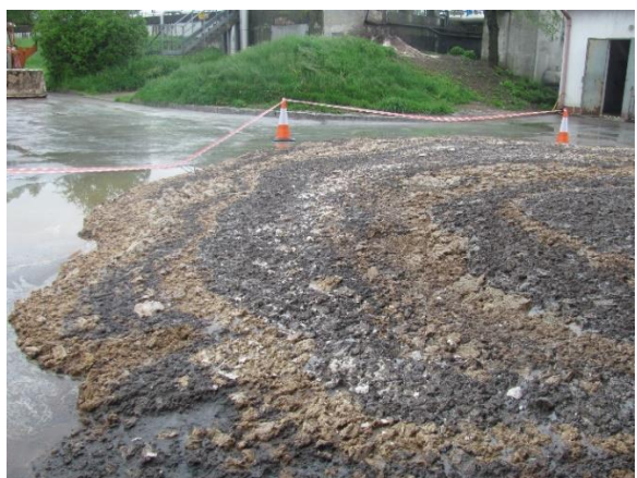
Składowanie osadu ściekowego (materiału skażonego biologicznie) w sposób niezapobiegający niekontrolowanemu rozprzestrzenianiu się
