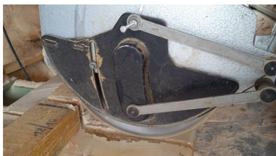
Pilarka tarczowa do cięcia poprzecznego. Nieprawny technicznie mechanizm samoczynnego opadania osłony piły
