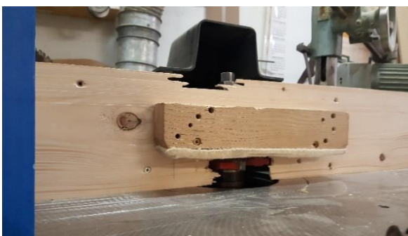
Bezpośredni dostęp do narzędzi roboczych frezarki dolnowrzecionowej, tj. freza oraz wrzeciona
