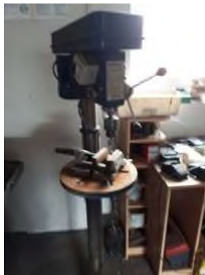
Niesprawną technicznie wiertarką stołową typu DEDRA (brak osłony niepracującej części wrzeciona oraz wyłącznika awaryjnego)
