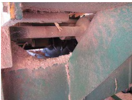
Brak osłon bądź innych skutecznych urządzeń ochronnych uniemożliwiających bezpośredni dostęp do pił pilarki tarczowej wielopiłowej do cięcia wzdłużnego
