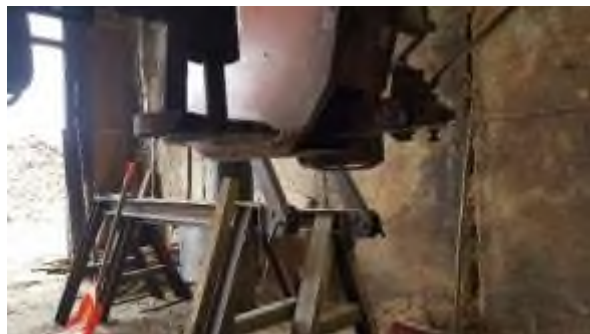
Brak osłon ograniczających dostęp do niepracującej części piły taśmowej oraz kół napędowych pilarki taśmowej do kłód
