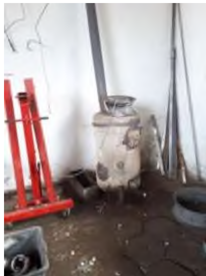
Stalowy piec grzewczy niewyposażony w osłony, które zabezpieczałyby przed możliwością poparzenia pracowników
