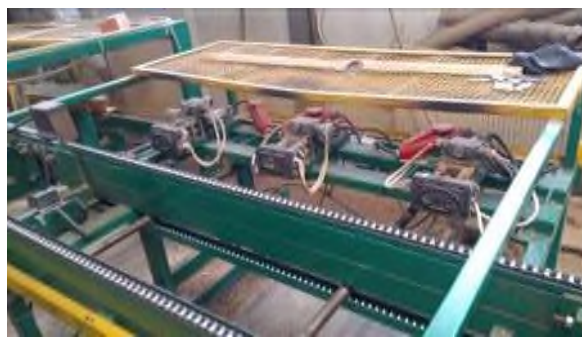
Możliwy dostęp do stempli wypalarki wsporników palet o wysokiej temperaturze linii do zbijania palet
