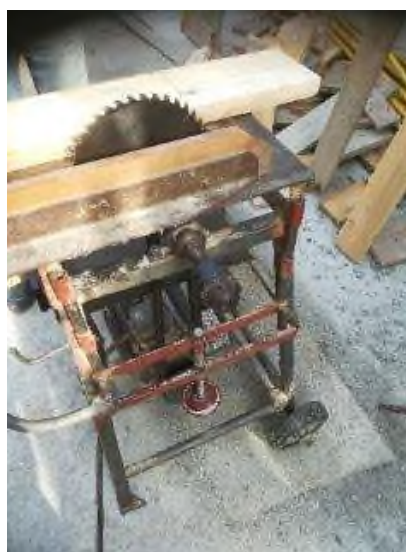
Pilarka tarczowa własnej konstrukcji nie wyposażona w wymagane osłony, klin rozszczepiający oraz elementy sterownicze. Na wale zainstalowano głowicę frezarską
