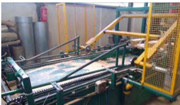
Dostęp do elementów ruchomych przewracarki palet, a także przenośników łańcuchowych oraz zębatek napędowych i zwrotnych linii do zbijania palet
