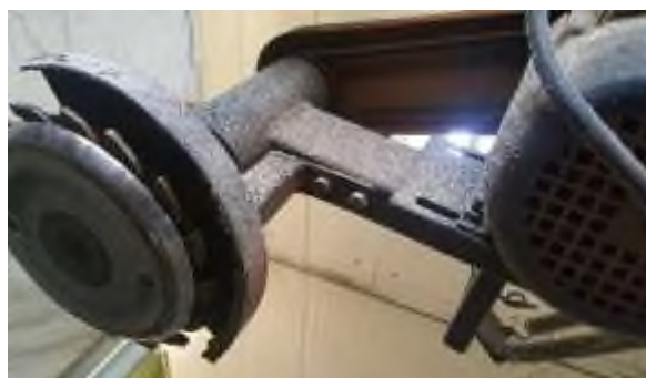
Brak pełnej osłony ograniczającej dostęp do strefy niebezpiecznej przekładni pasowej napędu korowarki oraz niepracującej części narzędzia pilarki taśmowej do kłód
